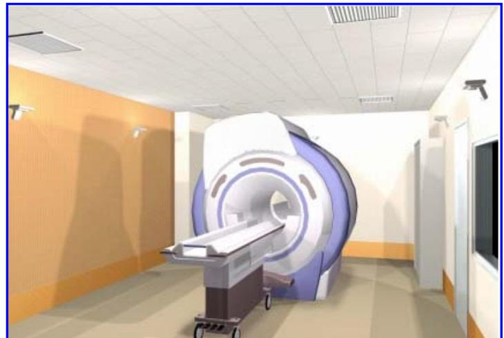
その信号の強弱や緩和時間などを基に画像処理を行うのがMRI装置の仕組みです。
